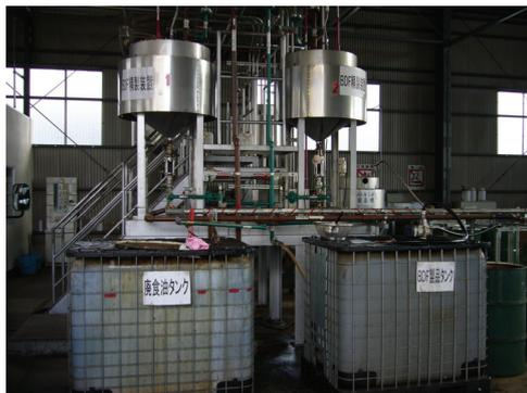
図 8-3 バイオディーゼル燃料製造装置
