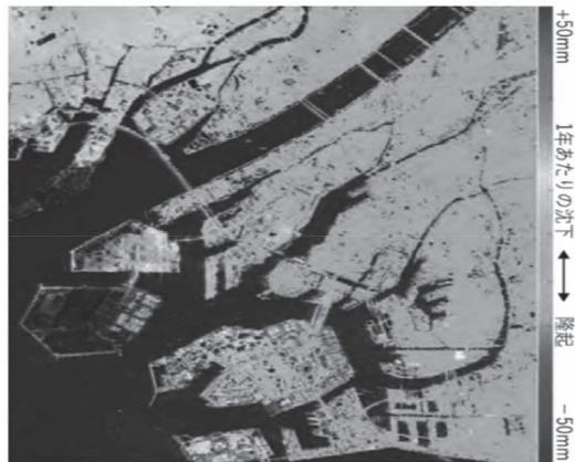
解析結果を例示した写真では、海上構造物の沈下傾向が陸地よりも大きいことが確認できます。
