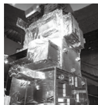
宇宙科学技術館に展示してある「だいち」の「熱・構造モデル」と呼ばれる試験機
