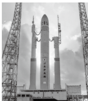
1段実機型タンクステージ燃焼試験(CFT)の際のH3ロケット試験機1号機
