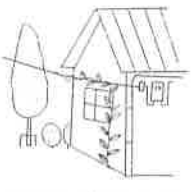
電線につるが落ちた場合、電線に近づくと感電の危険があります。
